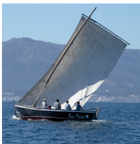
Leva un único mastro, bastante inclinado a popa, e unha vela de relinga.
